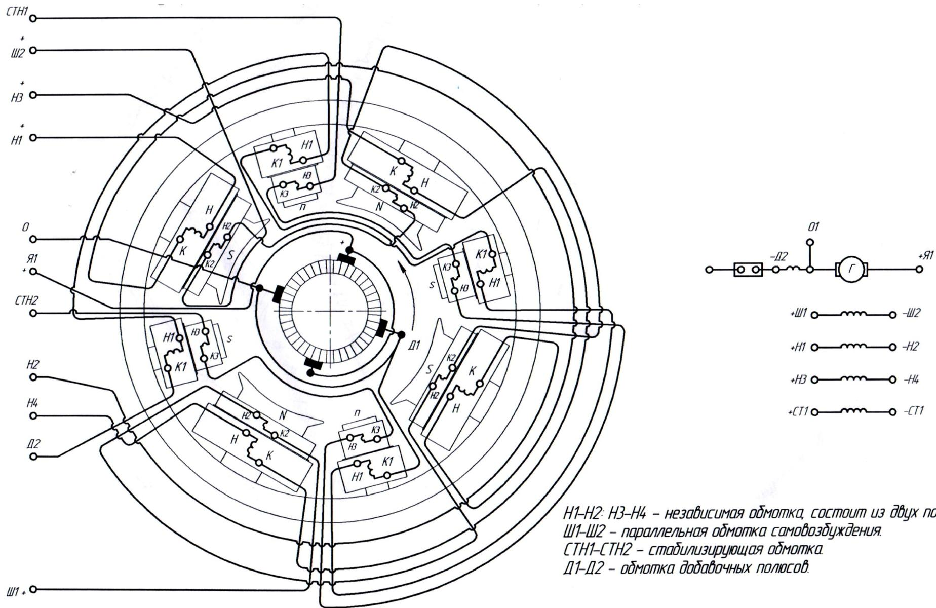
Схема внутренних электрических соединений генераторов серии 4ГПЭМ-125, 4ГПЭМ-170
